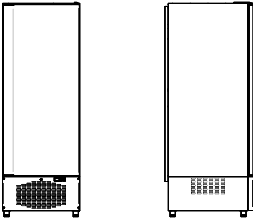
Рис. 1. ШХ-1,4-02; ШХ-1,4-03 с нижним расположением АКК
